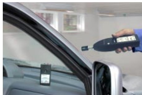
Control de estanqueidad con emisor ultrasonoro
